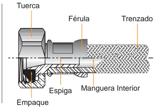
\*Trenzado que brinda máxima resistencia a la corrosión por ser fabricado con Acero Inoxidable Tipo 316L que soporta exposición a químicos clorados.
