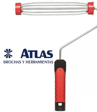
ESQUELETO PARA PINTAR 5 ALAMBRES "ATLAS". Mango jaula ComfyGrip, no desechables, para toda la línea "ATLAS" de rodillos de 38 mm (1 1/2") de diámetro. Puede ser usado con las extensiones "ATLAS". Adaptador con rosca que se usa o retira a su gusto. Diámetro 1 1/2"
