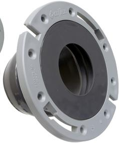
FLANGER CORTO PARA INODORO "COFLEX". Diámetro interior de 4" (100 mm), 18 cm de ancho y 8.5 cm de alto, para tubería de PVC, se adapta a tuberías ovaladas. Se puede usar en - Tubería normal, tubería inclinada, tubería con desfasamiento hasta 2.5 cm y tubería "T" o codo.
