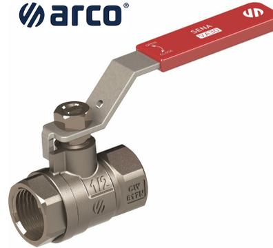
LLAVE DE BOLA "ARCO" SENA HEAVY DUTY "MODELO NUEVO". Cuerpo principal fabricado en latón europeo mediante estampación en caliente. Este proceso confiere al latón europeo las siguientes características frente a piezas fabricadas mediante fundición - Ausencia de poros y rugosidad. Mejor acabado superficial. Mayor resistencia mecánica frente a esfuerzos.
