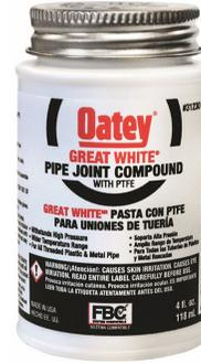
TEFLON EN PASTA "OATEY" 4 ONZAS (1/4 PINTA) U.S.A. No tóxica, no se endurece, no se separa y lubrica. Ajusta más y con menos torsión, para un sellado permanente y seguro de todas las conexiones roscadas. Permite un fácil desmontaje sin pelar ni dañar las roscas. Soporta hasta 3000 PSI en gases de -50 °F a 400 °F y 10 000 PSI en líquidos de -50 °F a 500 °F. Para usar con líneas de agua, vapor, cáusticos y ácido diluido.
