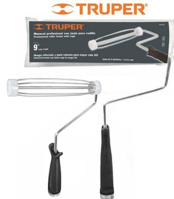
ESQUELETO PARA PINTAR 9" 5 ALAMBRES "TRUPER". Estructura de acero con varilla reforzada central de 6 mm, mango ergonómico y antiderrapante fabricado en polipropileno con adaptador para extensión. Diámetro 1 1/2"
