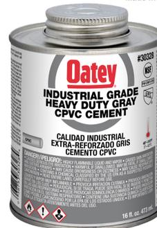
PEGAMENTO "OATEY"CPVC y PVC "CORZAN" LOVOC 1 PINTA. EXTRA-REFORZADO calidad Industrial. Para aplicaciones que requieren resistencia química a cáusticos, incluidos hipoclorito, ácidos minerales y soluciones salinas acuosas. Uso con todos los materiales de PVC, CPVC, CPVC Corzan®. Fácil de aplicar con el pincel incluido en la tapa. Su indicador UV permite una inspección rápida y sencilla de juntas de ajuste seco utilizando cualquier fuente de luz UV.
