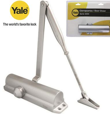
CIERRA PUERTA "YALE". 176 lbs / 180 Grados / Dos Ajustes. Para puertas hasta 80 kg, fuerza 2-3-4. Permite apertura hasta 180° (grados). Cuenta con dos válvulas independientes para control de velocidad inicial y cierre final.
