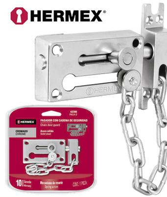
PICAPORTE CON CADENA "HERMEX" CROMADO. Cuerpo metálico y pasador de acero con cadena de seguridad. Botón con resorte. Ideales para puertas de entrada principal en domicilios y hoteles. Longitud de cadena 210 mm. Peso 220 g. Incluye tornillería.
