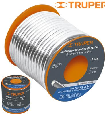
**TRUPER** SOLDADURA ESTAÑO 95/5 NUCLEO DE RESINA TUBERIAS DE GAS "TRUPER". 450g, alta resistencia a presión alta y temperatura, para instalaciones de gas, aire acondicionado, calefacción y refrigeración. Resistente a agentes corrosivos, libre de óxido, núcleo de resina, no requiere pasta, 95% de estaño, 5% de antimonio, diámetro 3 mm, punto de fusión 240 °C.
