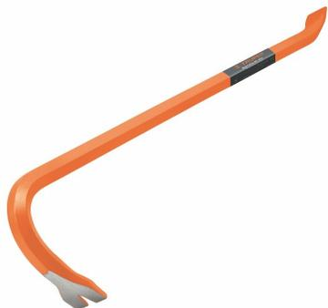
PATA DE CABRA CON UÑA "TRUPER". Fabricada de acero con doble tratamiento térmico, sección hexagonal, uña saca clavos y cincel pulido. Excede la norma - Especific. Federal - GGG-B-101b.
