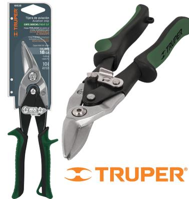
TIJERA "TRUPER" PARA HOJALATERO DERECHA, HOJAS DE ACERO. CORTE derecho, mangos ergonómicos confortables que permiten cortes fáciles, recubrimiento niquelado para mayor resistencia a la corrosión, hojas forjadas en acero al cromo 2x más resistentes al desgaste que las de acero al carbono. Longitud total - 9 5/8" Longitud de corte - 1 1/2"
