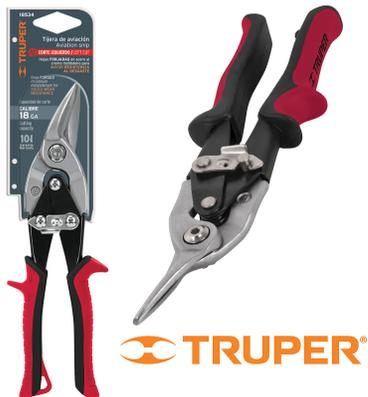
TIJERA "TRUPER" PARA HOJALATERO IZQUIERDA, HOJAS DE ACERO. CORTE izquierdo, mangos ergonómicos confortables que permiten cortes fáciles, recubrimiento niquelado para mayor resistencia a la corrosión, hojas forjadas en acero al cromo 2x más resistentes al desgaste que las de acero al carbono. Longitud total - 9 5/8" Longitud de corte - 1 1/2"
