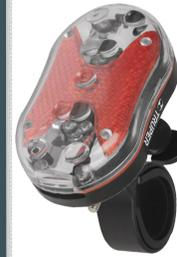
LINTERNA TRASERA PLASTICA "TRUPER" 2 baterías AAA, 9 LED. Luz roja fija y 6 diferentes destellos de luz, material del cuerpo ABS. Soporta salpicaduras de agua, lente plano, largo de 8 cm, soporte de polipropileno para tubos de 2.2 a 3.00 cm.
