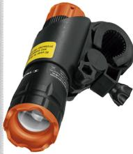
LINTERNA DELANTERA ALUMINIO "TRUPER", 3 baterías AAA, 1 LED. Iluminación alto, bajo e intermitente. Distancia 200 metros, alto (5 horas) bajo (24 horas). Material de cuerpo Aluminio. Lente de lupa. Haz de luz ajustable. Soporte de polipropileno para tubos de 2.2 a 3.00 cm.
