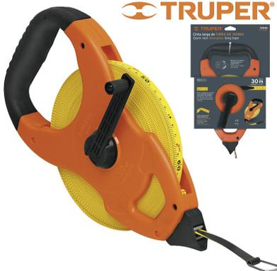
CINTA PARA INGENIERO "TRUPER" TIPO CRUCETA, recubierta de PVC permite que pueda mojarse y limpiarse fácil. Mango ergonómico con cubierta de goma. Cuerpo fabricado en ABS. Ideales para construcción, ingeniería civil y topografía. Cinta impresa por ambos lados. Ancho de la cinta 12.5 mm Espesor de la cinta 0.40 mm Escala cm-m / in-ft Color de la cinta Amarillo.
