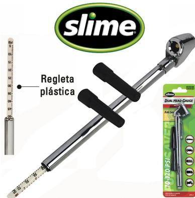
**MEDIDOR DE PRESION DE LLANTAS DE DOBLE CABEZAL "SLIME" CON EXTENSORES DE VALVULA 10 a 120 PSI.** Medidor de neumáticos tipo lápiz de doble cabeza, Incluye (2) extensores de válvula negros, cuerpo de manómetro cromado, la lengüeta de 4 lados mide psi, kPa y bar.
