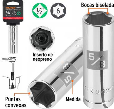
SOCKET "TRUPER" SACA BUJIA 6 PUNTAS 1/2 LARGO 5/8", fabricado en acero al cromo vanadio, inserto de neopreno que facilita la colocación de bujías. Sistema de sujeción Truper-Drive con puntas convexas que aseguran y aumentan el torque sin dañar tuercas ni cabezas de tornillos, medidas marcadas, bocas biselada para fácil identificación.
