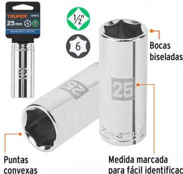
SOCKET "TRUPER" 6 PUNTAS 1/2 LARGO, fabricado en acero al cromo vanadio, resistente a la oxidación, sistema de sujeción Truper-Drive con puntas convexas que aseguran y aumentan el torque sin dañar tuercas ni cabezas de tornillos Bocas biseladas para acoplamiento rápido, medidas marcadas para fácil identificación. Exceden en promedio un 100% la norma en torque ASME B107.110
