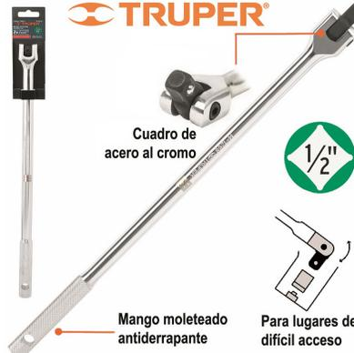
**MANGO ARTICULADO ACERO 1/2" TRUPER 17"**, fabricado de acero al cromo vanadio con diseños moleteados antiderrapante, Cuadros de acero al cromo molibdeno. Exceden en promedio un 45% la norma en torque ASME B107.110 Torsión máxima - 4,400 lb/in Dureza - 54 HRc.
