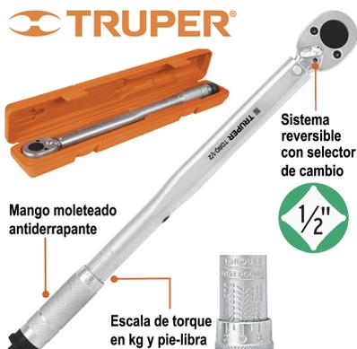
**TORQUIMETRO 18" 50-300 LB-FT TRUPER 1/2"**, Incluye estuche plástico. Cuerpo de acero al carbono, mango antiderrapante. Sistema reversible con selector de cambio de giro y botón de liberación rápida. Engrane de acero al cromo vanadio de 24 dientes. Escala de torque kilogramo-metro y pie-libra.
