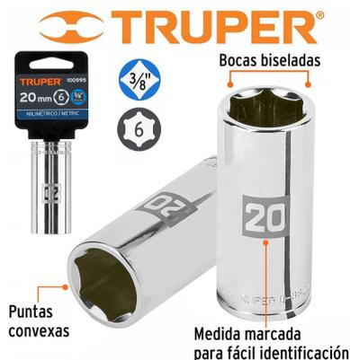
SOCKET "TRUPER" 6 PUNTAS 3/8 LARGO, fabricado en acero al cromo vanadio, resistente a la oxidación, sistema de sujeción Truper-Drive con puntas convexas que aseguran y aumentan el torque sin dañar tuercas ni cabezas de tornillos Bocas biseladas para acoplamiento rápido, medidas marcadas para fácil identificación. Exceden en promedio un 100% la norma en torque ASME B107.110
