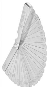
**CALIBRADOR AUTOMOTRIZ 26 HOJAS.** Fabricado en acero de manganeso. Graduación de 0.0015" a 0.025" (0.04 - 0.63 mm) "TRUPER". Excede la norma - Federal GGG-G17C.
