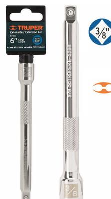
**EXTENSION PARA RATCHET 3/8" TRUPER 6"**, Fabricadas de acero al cromo vanadio, contiene balín. Exceden en promedio un 40% la norma en torque ASME B107.110. Diámetro - de 13 mm Torsión máxima - 1,200 lb/in Dureza - 60 HRC.
