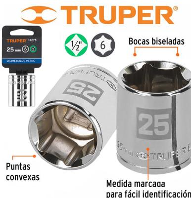
SOCKET "TRUPER" 6 PUNTAS 1/2 CORTO, fabricado en acero al cromo vanadio, resistente a la oxidación, sistema de sujeción Truper-Drive con puntas convexas que aseguran y aumentan el torque sin dañar tuercas ni cabezas de tornillos Bocas biseladas para acoplamiento rápido, medidas marcadas para fácil identificación. Exceden en promedio un 100% la norma en torque ASME B107.110
