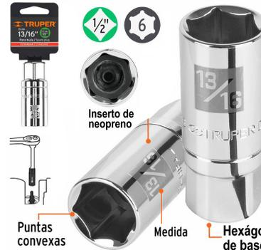
SOCKET "TRUPER" SACA BUJIA 6 PUNTAS 1/2 LARGO 13/16", fabricado en acero al cromo vanadio, inserto de neopreno que facilita la colocación de bujías. Hexágono de base para acoplar otro dado o llave. Sistema de sujeción Truper-Drive con puntas convexas que aseguran y aumentan el torque sin dañar tuercas ni cabezas de tornillos, medidas marcadas, bocas biselada para fácil identificación.
