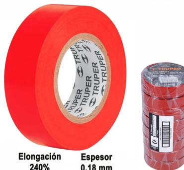
**GUTAPERCHA 60 PIES EN BLISTER "TRUPER".** Cintas fabricadas en PVC con base de adhesivo acrílico, aislamiento eléctrico en alambres y cables con capacidad nominal hasta 500 V. Temp. mínima - 0 °C (32 °F) Temp. máxima - 800 °C (176 °F) Largo - 18 m Ancho - 19 mm Espesor - 0.18 mm Elongación máxima - 240%
