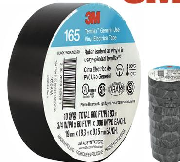
**GUTAPERCHA NEGRA "3M" 3/4" x 60 pies TEMFLEX.** Fabricada PVC, ideal para instalaciones eléctricas, retardante de flama, con capacidad nominal de hasta 600v. Temp. mínima 0 °C (32 °F) Temp. máxima 90 °C (194 °F) Largo 18 m Ancho 19 mm Espesor de 0.15 mm Elongación máxima 200%.
