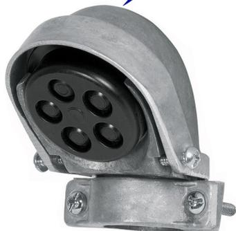
TIPO DE ENTRADA "VOLTECK" 1" y 1 1/4". Con abrazadera para tubo, cuerpo en aluminio y base ABS, para kit CFE e instalación de cableado eléctrico y protección contra agua y corto circuito. Medida - 1"
