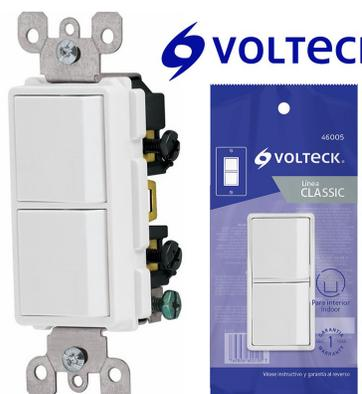
**INTERRUPTOR DOBLE "CLASSIC" BLANCO "VOLTECK".** Fabricado en nylon-policarbonato, soporte de acero galvanizado. Cumple con la norma - NOM-003-SCFI. Tipo interruptor - Dúplex Tensión 120 V/ Corriente 15 A / Frecuencia 60 Hz Dimensión ventana - 66.55 mm x 33.02 mm.
