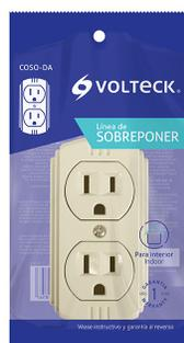
**TOMA DOBLE "VOLTECK" SOBREPONER POLARIZADO**, tensión 127 V y corriente 15 A. 2 Polos + tierra, incluye tapa trasera, fabricado en baquelita, cumple con la norma - NOM-003-SCFI. Polarizado - que obliga a entrar en una sola posición, Aterrizado, 3 puntos de conexión - Línea, neutro y de tierra física, que protege contra una descarga eléctrica.
