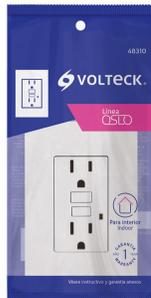
TOMA DOBLE "OSLO" CON FALLA A TIERRA "VOLTECK". Fabricado ABS y policarbonato. Nivel de disparo - Clase A, 6mA Botón de restablecimiento, botón prueba, led indicador de voltaje en línea.
