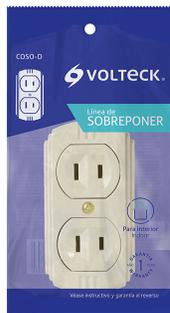
**TOMA DOBLE "VOLTECK" SOBREPONER** tensión 127 V y corriente 15 A. Sin tierra, incluye tapa trasera, fabricado en baquelita, cumple con la norma - NOM-003-SCFI. Polarizado - el contacto tiene una ranura mas ancha que la otra y de esta forma está obligado a entrar en una sola posición, para no conectarse erróneamente. Para interiores.
