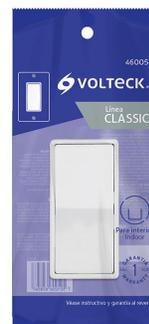
INTERRUPTOR SENCILLO "CLASSIC" BLANCO "VOLTECK". Fabricado en nylon-policarbonato, soporte de acero galvanizado. Cumple con la norma - NOM-003-SCFI. Tipo interruptor - Sencillo Tensión 120 V/ Corriente 15 A / Frecuencia 60 Hz Dimensión ventana - 66.55 mm x 33.02 mm.
