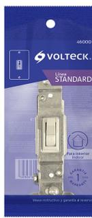
INTERRUPTOR SENCILLO "VOLTECK" MARFIL. Tensión 120 V y corriente 15 A. Fabricado nylon-policarbonato. Soporte de acero galvanizado. Interruptor de palanca. Ideal para uso en interiores. Cumple norma - NOM-003-SCFI
