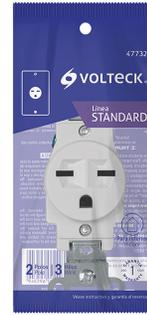
**TOMA SENCILLO "VOLTECK" BLANCO**. Tensión 250 V y corriente 15 A. Fabricado nylon-policarbonato. Alta tensión 2 polos. 3 hilos. Aterrizado 3 puntos - línea, neutro y de tierra física. Cumple con la norma - NOM-003-SCFI
