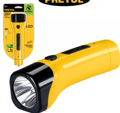
LINTERNA RECARGABLE 1 LED "PRETUL". Mayor luminosidad y alcance de 50 Lúmenes/ Distancia 40 metros, Durabilidad de Batería 6 horas. Se conecta directamente a la corriente eléctrica, contiene 1 batería recargable de plomo-ácido de 4Vc. Lente plano.
