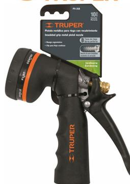
PISTOLA METALICA CON RECUBRIMIENTO 8 FUNCIONES "TRUPER". Cuerpo metálico recubierto con doble inyección ABS/TPR, clip para flujo continuo, cabeza giratoria para ajustar a la función elegida. Funciones - Completo, Niebla, Jet, Regadera, Angulo, Plano, Centro y Cono.
