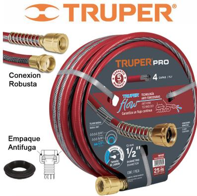
MANGUERAS DE 1/2" "TRUPER PRO" compuesta de 4 CAPAS Con refuerzo de tejido radial resistente a la alta presión, con tecnología Anti-Torcedura. Empaque anti-fuga con diseño cónico. Conexiones metálicas robustas de máxima durabilidad con resorte que protege la manguera y evita deformaciones. Para uso Domestico.
