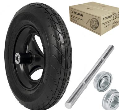
LLANTA PARA CARRETILLA LIGERA "TRUPER" COMPLETA. (Eje y Baleros). Rin fabricado en acero con acabado en polvo poliéster negro, eje en acero. Exceden la norma - GB1702-92. Ancho/Diámetro - 4" x 16". Diámetro de rin - 8". Presión de inflado - 20 a 25 PSI. Diámetro del eje - 5/8". Número de balines - 12
