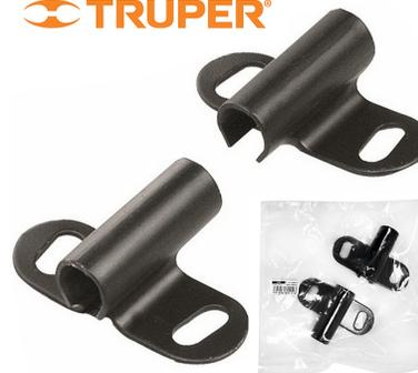
REPUESTO MARIPOSA CON OREJAS "TRUPER" PARA EJE DE CARRETILLA 2 PIEZAS. Fabricadas en lámina de acero al carbono calibre #14, acabado de pintura en polvo poliéster color negro. Exclusivo para carretillas. Ancho - 83 mm. Longitud - 55 mm
