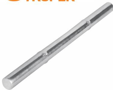
EJE PARA CARRETILLAS "TRUPER" 9 1/2". Fabricado en acero al carbono, usado para carretillas con bastidor tubular y de madera, acabado galvanizado. Exclusivo para carretillas. Diámetro - 5/8". Longitud - 22 cm
