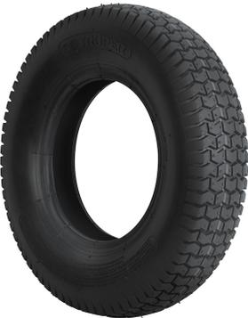
LLANTA PARA CARRETILLA REFORZADA "TRUPER" SOLA DE 4 CAPAS. Llanta neumática reforzada, diseño robusto y resistente al desgaste, rodada para estabilidad. Sin cámara. Excede la norma - GB1702-92. Ancho/Diámetro - 4" x 16" Número de capas - 2 Presión de inflado - 20 a 25 PSI
