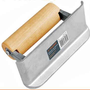
**MARCADOR DE ESQUINA "TRUPER".** Fundido en aleación de aluminio de 380 que proporciona resistencia a la corrosión. Crea borde con acabado liso en banquetas, losas, escaleras, etc.
