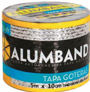
LAMINA DE ASFALTO "ALUMBAND" AUTO-ADHESIVO "TAPA GOTERAS" 2 mm. COLOR ALUMINIO. Para la reparación e impermeabilización de techo (planos, inclinados, bóvedas, etc) es flexible, se acopla a cualquier forma de superficie.
