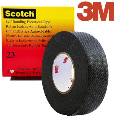
CINTA ELÉCTRICA 23 "3M SCOTCH" Hule Autofusión 3/4" x 30 Pies. Es una cinta de empalme de caucho de primera calidad, negra, compuesta por un respaldo de caucho de etileno propileno (EPR). Utilizado como aislamiento primario para aplicaciones de termino y empalme de cable hasta 69 kV (ASTM D4388, Tipo III). Temperatura de funcionamiento nominal 194 °F (90 °C), clasificación de sobrecarga de emergencia de 266 °F (130 °C).
