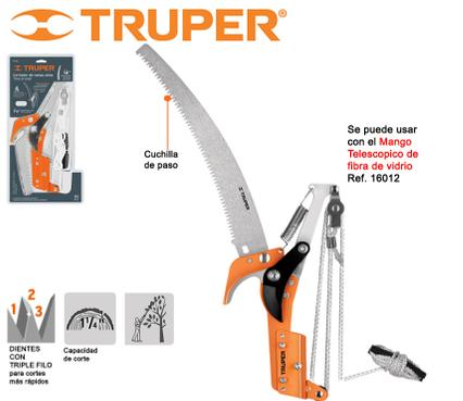
CORTADOR DE RAMAS "TRUPER" 14" SIN MANGO, Hoja de acero SK5, templada, máxima duración de ?lo. Cuchilla de paso. Sistema de polea para reducir el esfuerzo al cortar.
