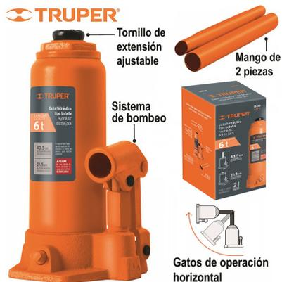
GATO HIDRAULICO DE CILINDRO TRUPER TONELADAS, Puede utilizarse para empujar elementos en forma horizontal, cuidando que el sistema de bombeo quede hacia abajo. Cabeza maquinada que reduce el deslizamiento de la carga. Con dispositivo de extensión (tornillo), el cual incrementa la altura máxima.
