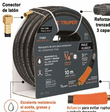
**MANGUERAS DE CAUCHO PARA COMPRESOR "TRUPER".** Para uso RUDO. Excelente resistencia a los aceites, grasas y abrasión. Manguera trenzada 3 capas, antitorsión para evitar rupturas y reducir desgaste, conectores de latón. Alta flexibilidad Presión máxima - 300 psi / 2,068 kPa Diámetro interno - 3/8" Espesor de pared - 3.5 mm Peso por metro - 270 g/m Conexión - 1/4" NPT
