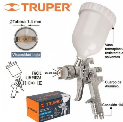
**PISTOLA AIRE VASO PLASTICO "TRUPER"** 500 ml. Alto Volumen baja Presión. Para uso industrial y automotriz. Tobera y aguja de acero inoxidable, Boquilla. Para materiales de base agua y solvente Presión óptima de trabajo - 30 - 50 psi. Diámetro tobera - 1.4 mm. Tamaño de abanico - 18 - 25 cm. Consumo aire - 8 CFM (227 L/min).
