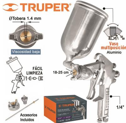
**PISTOLA AIRE VASO ALUMINIO "TRUPER"** 400 ml. Bajo Volumen Media Presión. Ideales para uso industrial. Tobera y aguja de acero inoxidable Boquillas de latón galvanizado con pulverizado fino 3 perillas de control - flujo de aire, flujo de material y tamaño de abanico. Presión óptima de trabajo - 30 - 50 psi. Diámetro de tobera - 1.4 mm. Tamaño de abanico - 18 - 25 cm. Consumo aire - 6 CFM (170 L/min).
