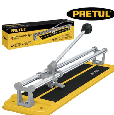
**CORTADOR DE AZULEJO. ( Y cuchillas "PRETUL" 400 mm (15 3/4").** Base en acero con hule antiderrapante, cuchilla circular fabricada en carburo, corte de cerámica o azulejo. Capacidad de corte 10 mm
