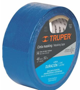
CINTA MASKING TAPE AZUL "TRUPER" LONGITUD 50 METROS. Adherencia baja, 21 días para remoción limpia, ideal para trabajos que requieren permanencia de hasta por 3 semanas sin dejar residuos, adhesivo emulsión acrílica y espesor de 0.13 mm.
