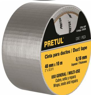
**CINTA PARA DUCTO "PRETUL" 0.16 MM.** Resistente al desgaste y la abrasión, resistente a la humedad, mayor adaptación a superficies irregulares, polietileno reforzado con malla de algodón, adhesivo hot melt. Ancho 48 mm, elongación 10%, resistencia a la tensión 130 kgf/cm<sup>2</sup>, temperatura máxima 60° C.
